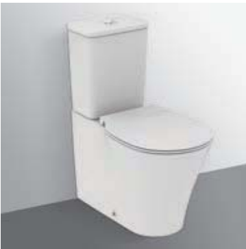
Vaso per cassetta filo parete AquaBlade® completo di sedile slim a sgancio rapido. Certificato per scarico 4,5/3 litri. Scarico traslato che copre distanze comprese tra 60 e 200 mm grazie all'utilizzo di apposite curve tecniche.
