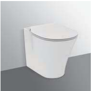
Vaso filo parete AquaBlade® con sedile slim a sgancio rapido e fissaggi completamente nascosti. Scarico traslato che copre distanze comprese tra 60 e 200 mm grazie all'utilizzo di apposite curve tecniche.
